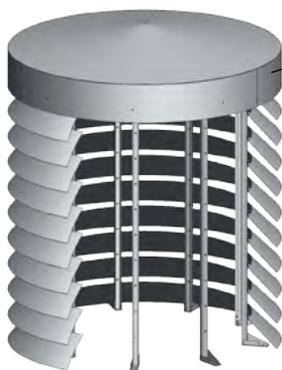
**Lamellenkopf bestehend aus "Haube - Streckmetall - Lamellen"**
