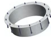
Ein Sockelrohr kann nach Fertigstellung des Fundamentes notwendig sein, um Betonarbeiten nicht zu behindern oder eine Geländeanhebung auszugleichen. Hierbei wird der bereits vergossene Ankerkorb als Befestigung genutzt. Der Lüftungsturm kann später, nach Abschluss der bauseitigen Abklebung und Geländegestaltung, definiert auf den Sockel aufgeschraubt werden.
