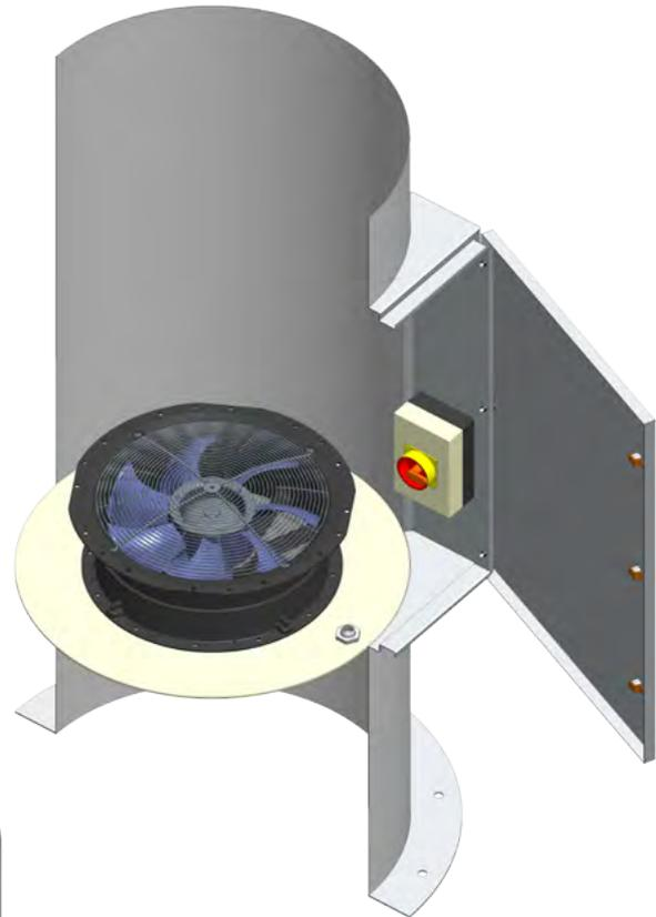
Bei einer Langlochform können mehrere Ventilatoren in einer Reihe aufgebaut werden.
