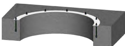
**Befestigung auf bauseitigem Fundament**
