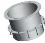
Um eine spätere Aufbauhöhe des Lüftungsturmes zu erreichen, empfehlen wir die Ankerkorbvariante mit Sockelrohrverlängerung. Hierbei wird der Ankerkorb mit einem durchgehendem Sockelrohr hergestellt, das gleichzeitig als verlorene Schalung dient. Der Lüftungsturm wird später auf dem aufgeschweißten Stoßflansch definiert aufgeschraubt. (Höhere Sockelhöhen auf Anfrage).
