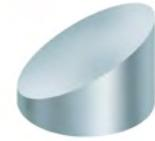
**Schräghauben bieten wir mit einer Neigung von 5°, 10°, 15°, 30° und 45° an.** (Sonderabmessungen nach Absprache möglich). Die Schräghaube wird bis zu einem Durchmesser von 850 mm produktionsbedingt mit geringer Überwölbung gefertigt. Ab einem Durchmesser von 900 mm werden alle Hauben mit einer definierten Überwölbung hergestellt, um einer Schneelast besser widerstehen zu können. Ebenfalls wird durch diese Formgebung das anfallende Regenwasser schnell seitlich abgeleitet.
