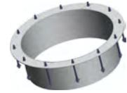
Bei dieser Ankerkorbausführung wird ein Rohrstück als verlorene Schalung in den Ankerring eingehaftet. Diese Schalung verbleibt nach dem Vergießen im Fundament und bildet einen definierten Randabschluss zum Lüftungskanal. Die verlorene Schalung erleichtert die Betonarbeiten bei der Erstellung des Fundamentes.
