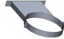
Eine Wandanbindung überträgt horizontale Kräfte auf den Baukörper. Die auftretenden Kräfte müssen vom Baukörper aufgenommen werden (Betondecke/Stahlbau). Die Befestigung der Wandanbindung erfolgt durch zugelassene Dübel.
