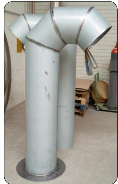
Ablufttürme mit 135° Segmentbogen, gefertigt aus verzinktem Vormaterial vor der Beschichtung.
